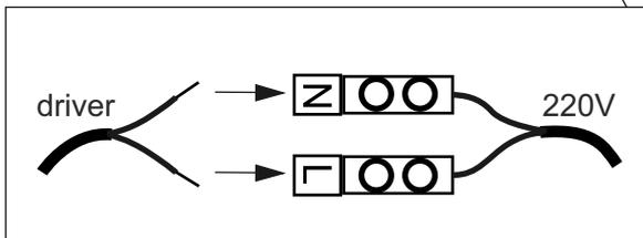
**ВАЖНО:** Установка светильника должна производиться при обесточенной электросети.
